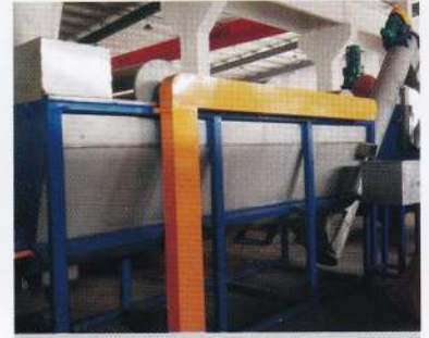
双螺杆漂洗池
